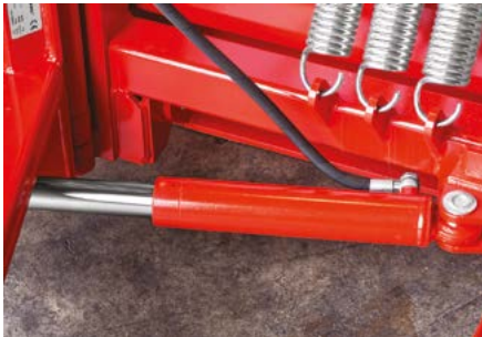
HIDRAVLICNO obračanje / hidravlični sistem omogoča obračanje deske v smeri levo in desno za poljuben kot, ki ne presega 35 stopinj
