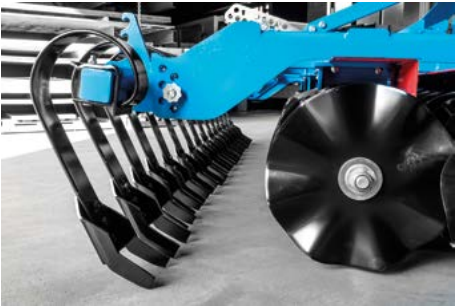
RAVNALNI ELEMENTI / odlikuje ga sistem po višini nastavljenih obdelovalnih peres, ki jim po potrebi lahko / spreminjate tudi obdelovalni naklon
