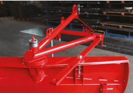
ROČNA NASTAVITEV KOTA / 3 Stopenjska nastavitev do max 35°
