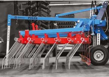
ZAPOREDJE / visoko učinkovitost česala zagotavlja medsebojno dopolnjevanje posamičnih elementov, ki so razporejeni v naslednjem vrstnem redu: nivojsko kolo, ravnalna deska in 6 vrst vzmetnih peres
