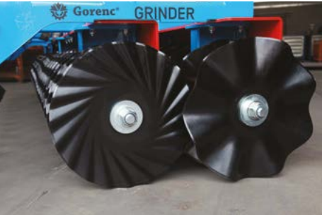
TURBO DISKI / zaradi čvrstejšje konstrukcije agresivneje zazežajo v obdelovalno površino. / učinkovito obdelajo tudi zahtevnejše vrste tal. / maksimalni učinek dosežejo v kombinaciji z valovitimi diski.
