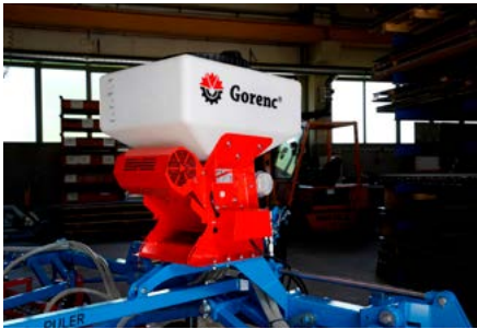
NOSILEC SEJALNICE / namenski nosilec za pritrditev pnevmatskih sejalnic
