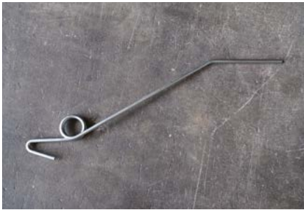
VZMETNO PERO / dolžina 450 mm / fi 6 mm za lahko zemljo / fi 7 mm univerzalno vzmetno pero / fi 8 mm za težko zemljo, kamnita tla, travlinje
