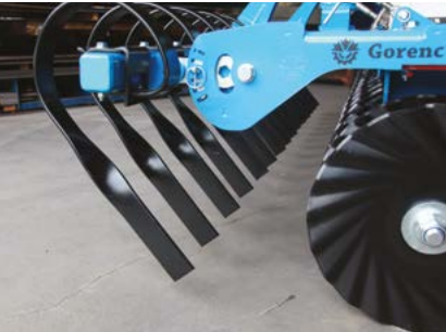
REZALNI ELEMENTI / omogočajo nastavljalnost po višini in spreminjanje naklona. / zaradi čvrste konstrukcije so primerna za obdelavo težjih vrst tal. / zagotavljajo neprekinjen prehod brez zatikanja in zaustavljanja.
