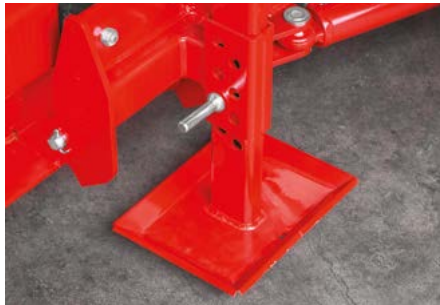
SMUČI / omogočajo poljubno nastavitve višine pluga / čvrst mehanizem in velika naležna ploskev smuč zagotavljata, da se oddaljenost pluga od tal med delom ne spreminja
