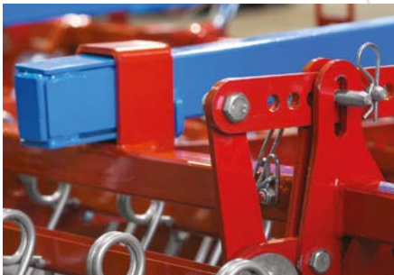
NASTAVITEV KOTA VZMETNIH PERES / hitra in enostavna nastavitev kota [opcijsko hidravlično*]
