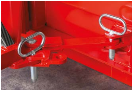
ROČNO OBRAČANJE / s pomočjo enostavnega mehanizma lahko ročno spreminjate kot pluga in izbirate med 23 in 35 stopinjskim naklonom
