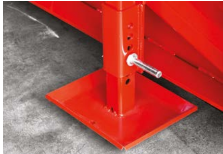
SMUČI / omogočajo poljubno nastavitev višine pluga / čvrst mehanizem in velika naležna ploskev smuč zagotavljata, da se oddaljenost pluga od tal med delom ne spreminja
