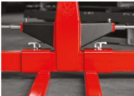
TRANSFER SUPRA M /omogočajo nastavljivost po širini / presek vilic 100×50
