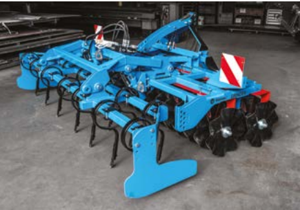
2L - DVE VRSTI PERES / odlikujeta ga dve vrsti S-peres z ravnimi noži / zaradi močnega preseka zagotavlja večjo moč in učinkovitost / primeren za obdelavo težjih podlag / omogoča hidravlično nastavitev naklona in globine obdelave / ponuja možnost računalniškega krmiljenja hidravličnega sistema
